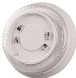
DI-9406-RU База со встроенным свето-звуковым оповещателем. Звуковое давление 92дБ. Для детекторов серии DI
