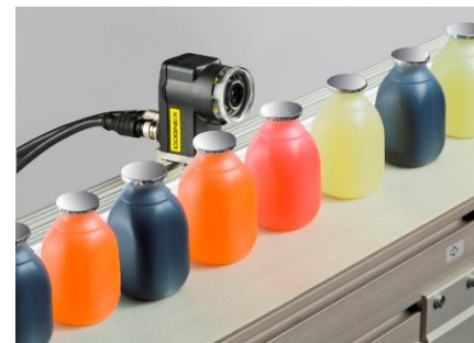
Проверка и идентификация изделий на основе цвета
