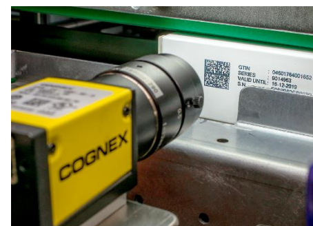
Считывание 1D и 2D кодов на этикетках и изделиях
