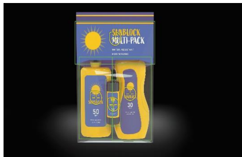
Проверка правильности сборки изделий
