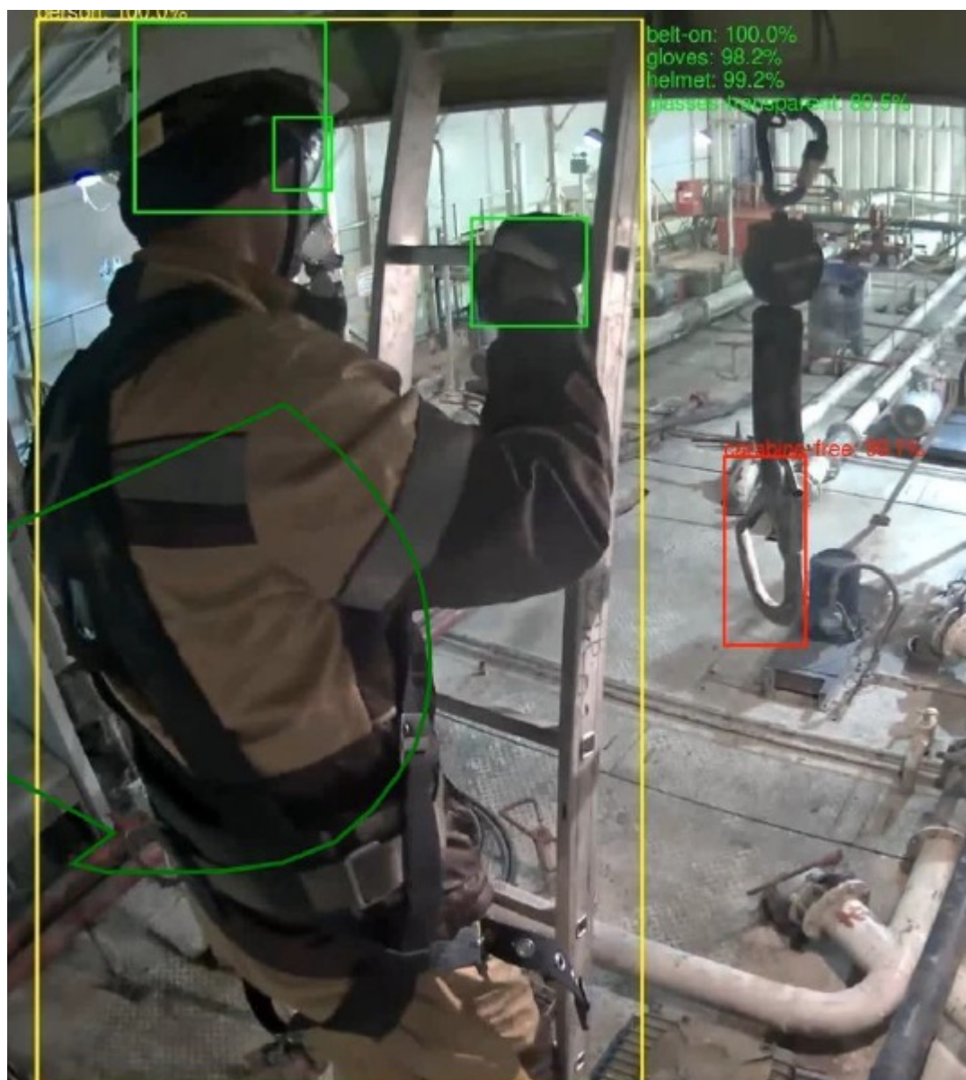
Рисунок 3. Работа системы видеоаналитики (фиксация применения страховочной привязи (работа на высоте); фиксация использования специальной одежды и обуви, средств защиты; фиксация нахождения в запрещенной зоне; оповещение в режиме реального времени ответственных сотрудников о зафиксированных нарушениях; сбор и хранение данных)
