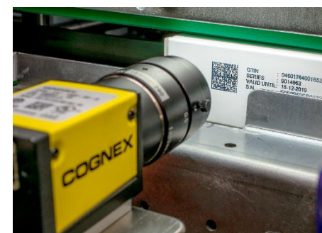
Считывание 1D и 2D кодов на этикетках и изделиях
