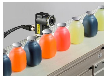
Проверка и идентификация изделий на основе цвета
