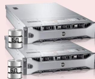
Сервер PRO-WATCH VMS с резервированием
